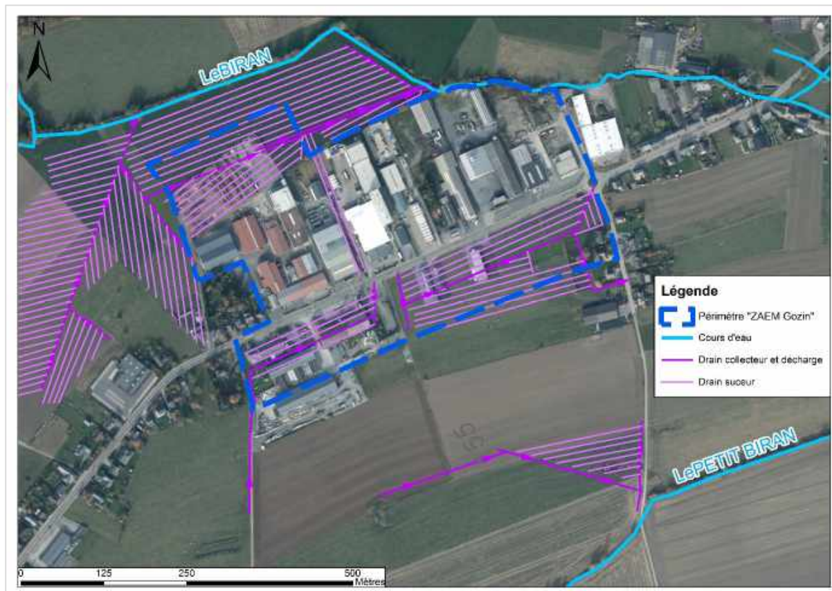
Figure 23 : Réseau de drainage mis en place dans le cadre du remembrement de Focant entre 1984 et 1990
